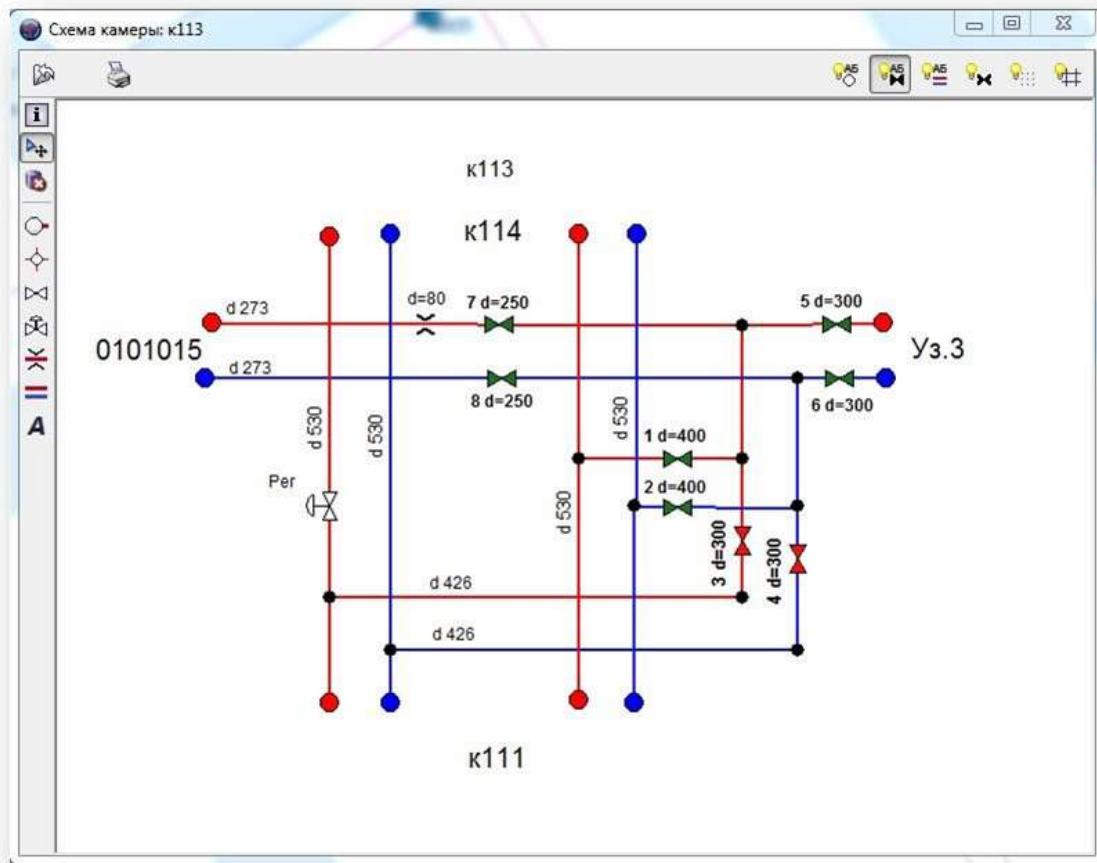
Рисунок 6 – Схема элемента «Тепловая камера»
