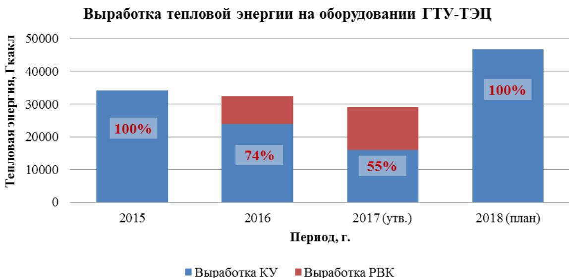
**Рисунок 5 – Балансы выработки тепловой энергии на оборудовании ГТУ-ТЭЦ**
