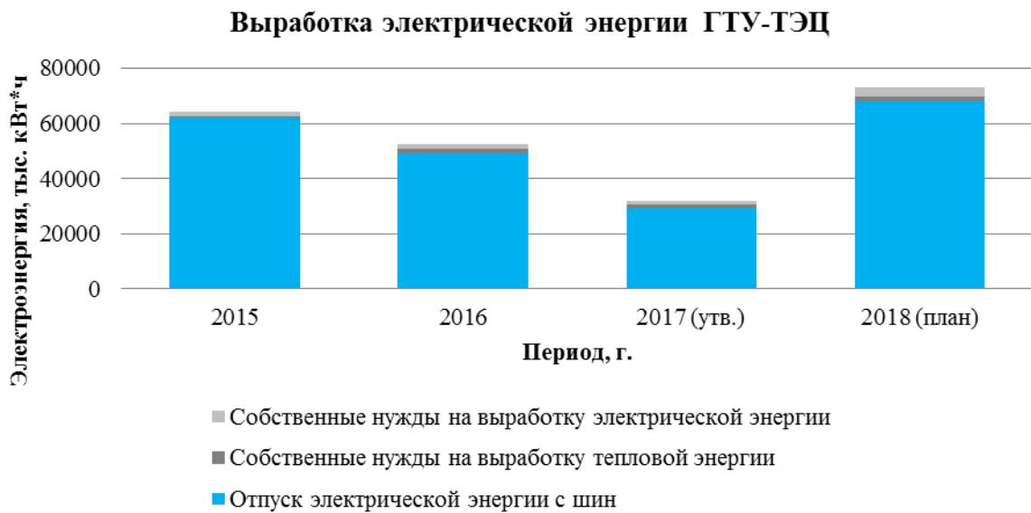
**Рисунок 6 – Балансы выработки электрической энергии на оборудовании ГТУ-ТЭЦ**
